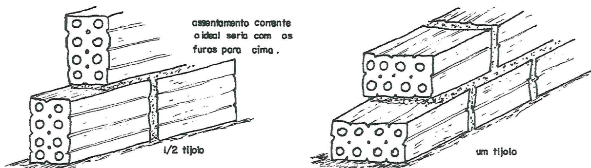
Figura 1 - Execução de alvenaria utilizando tijolos furados.
