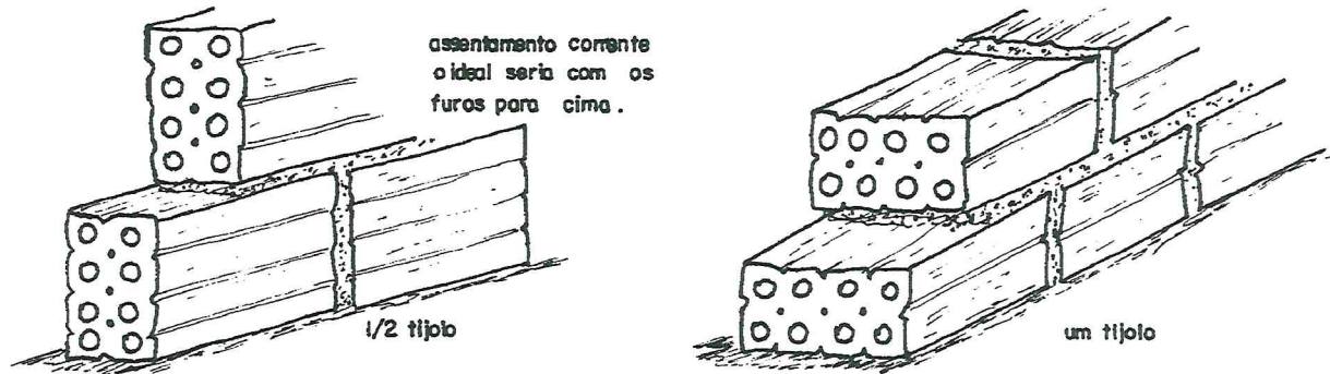
Figura 1 - Execução de alvenaria utilizando tijolos furados.
