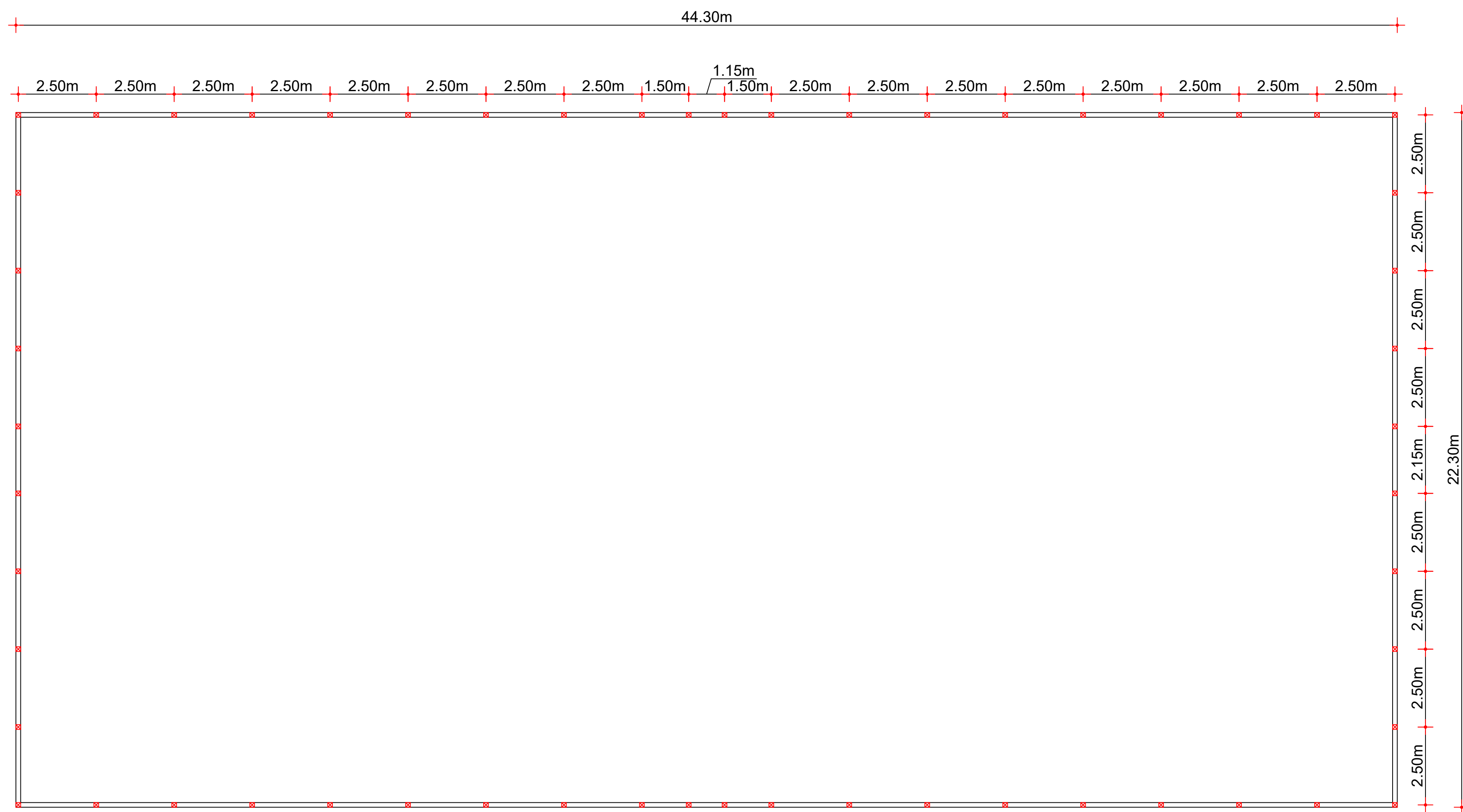
PLANTA LOCAÇÃO DOS PILARETES DA MURETA
