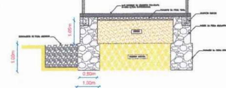
CORTE TRANSVERSAL (BALIZADOR)
